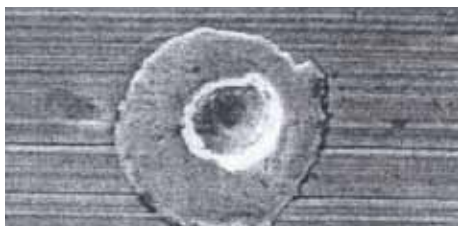
Cráter ocasionado por electroerosión en la pista interna del rodamiento.
